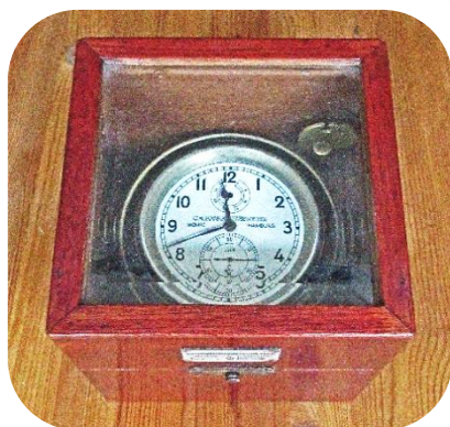
Mahagoni-Kasten mit den Hamburger Maßen 185 x 185 x 185 mm – Gesamtgewicht 3925 g originale Holzgriffe - Klappdeckel mit facettiertem Glas - Instrumentenschild aus Aluminium
