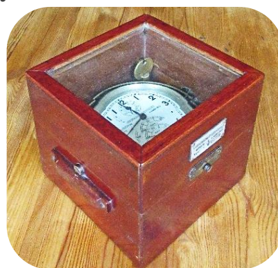
Mahagoni-Kasten mit den Hamburger Maßen 185 x 185 x 185 mm – Gesamtgewicht 3925 g originale Holzgriffe - Klappdeckel mit facettiertem Glas - Instrumentenschild aus Aluminium
