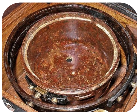
Gehäuse, Kardan- und Glas-Ring aus Pressstoff - Werksoberflächen ohne Ringelung - Stahlband statt Aufzugskette
