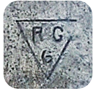
Eine Guillaume-Unruh (32,3 \mu x 3,8 mm) aus Nickelstahl-Messing von R. Griebbach in Glashütte. Richard Griebbach stempelte seine Unruhen auf einem Unruhschenkel - 1939 war am Stempel die rechte Ecke vom Dreieck weggebrochen.
