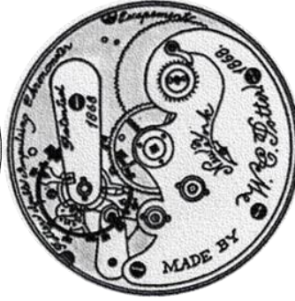
W. C. Potter – erst Chicago, später New York – rechts ein V&C-Werk in der Mitte ein „double impulsing chronometer escapement“
