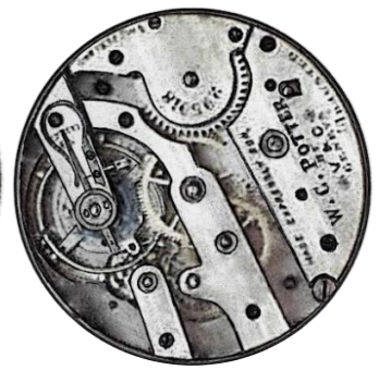
W. C. Potter – erst Chicago, später New York – rechts ein V&C-Werk in der Mitte ein „double impulsing chronometer escapement“
